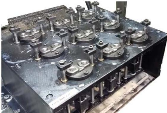
Ejemplo: sujeción para mecanizado de piezas de fundición.
