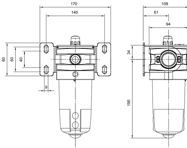
Tipo..... Unidad brida intermedia para toma de presión auxiliar
