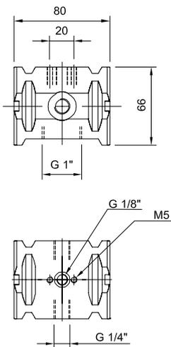
Tipo..... Válvula 3/2 NC cuya función es interrumpir el suministro de aire y poner a descarga el circuito. El pasaje se restituye accionando manualmente la actuación
